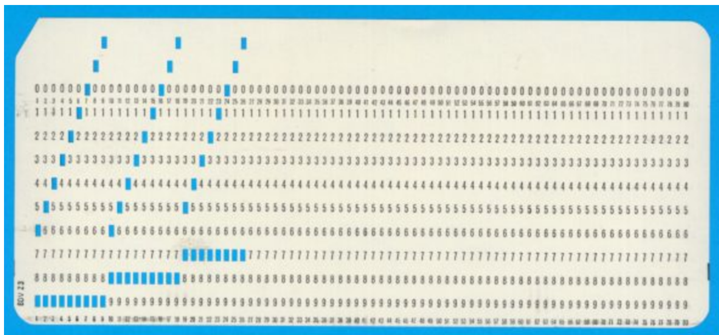
Figura 72.13. La scheda perforata classica, da 80 colonne.
