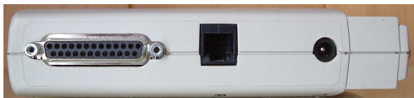
Figura 35.6. La parte posteriore di un modem esterno tipico. Si può osservare il connettore seriale sulla parte sinistra.
