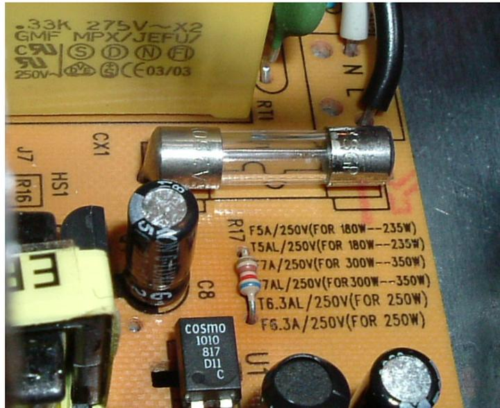
La sostituzione del fusibile deve avvenire utilizzandone un altro con le stesse caratteristiche. Generalmente si tratta di fusibili rapidi (lettera «F», per *fast*) e la corrente va letta sulla coroncina metallica del fusibile stesso. Eventualmente, si può stimare il valore della corrente di un fusibile, in base alla potenza che deve essere erogata dall'alimentatore, come si vede nel grafico contenuto nella figura successiva.
