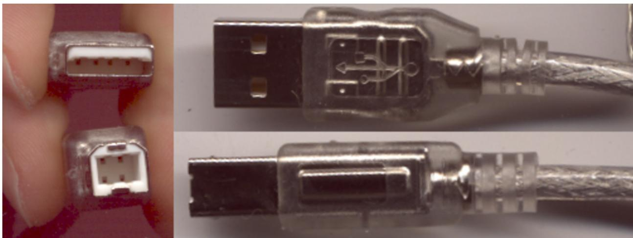
Il bus USB consente di collegare un massimo di 127 dispositivi, oltre all'unità di controllo. In questo numero vanno contati anche i concentratori. A differenza del bus SCSI, qui i dispositivi non devono essere numerati manualmente, perché a questo provvede automaticamente il sistema.
