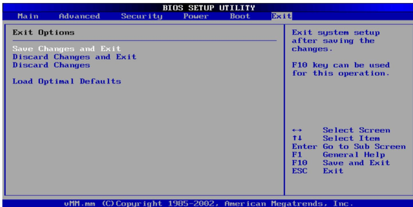
Figura 9.96. Programma di configurazione di un BIOS AMI con menù grafico: menù principale.<sup>2</sup>
