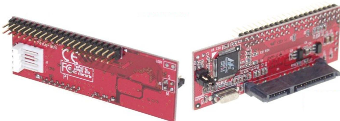
Figura 9.45. Adattatore da bus SATA a disco PATA. Questo adattatore di applica al disco PATA.
