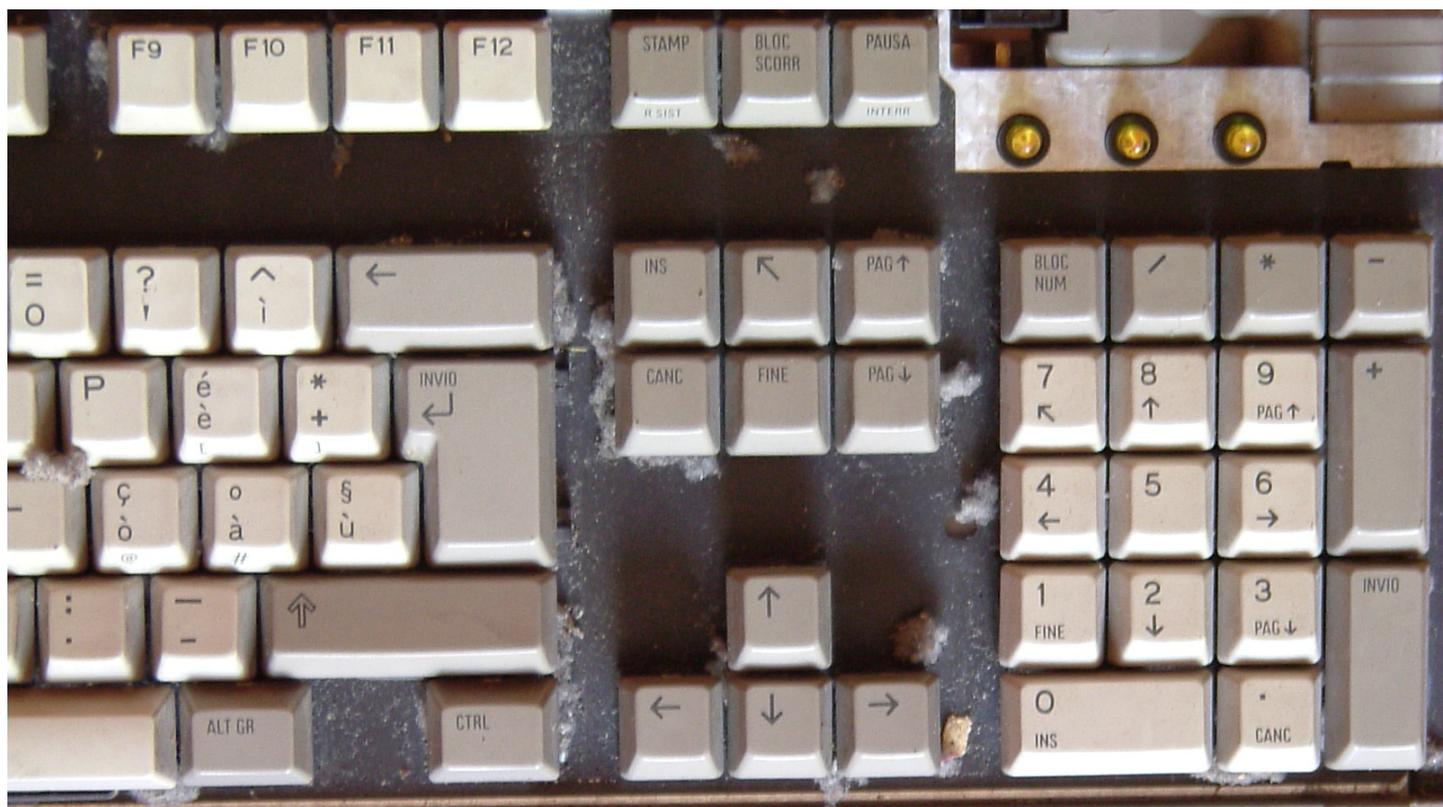
Figura 9.135. Una tastiera Olivetti degli anni 1990, prima della pulizia, dopo l'estrazione di tutti i tasti. Viene messo in evidenza quanta sporcizia si accumuli sotto i tasti.
