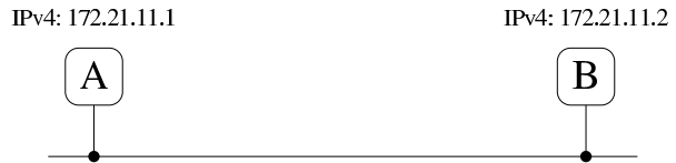
Figura 83.140. Esempio di pacchetto «ping», inviato dall'indirizzo 172.21.11.1 a 172.21.11.2. Il pacchetto IPv4 non è frammentato ( MF == 0) e non è nemmeno frammentabile ( DF == 1).
