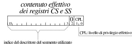
Figura 83.7. Interpretazione dello stato dei registri CS e SS .
