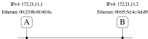
Figura 83.133. Situazione ipotetica di due nodi che utilizzano il protocollo ARP.
